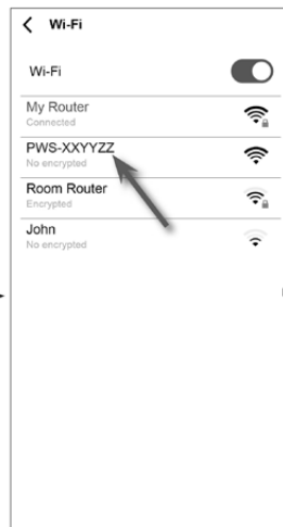
(c) Vybere název sítě Wi-Fi konzoly (název vždy začíná znaky PWS-) pro připojení vašeho smartphonu ke konzole. Pak klepněte zpět na aplikaci WSLink.
